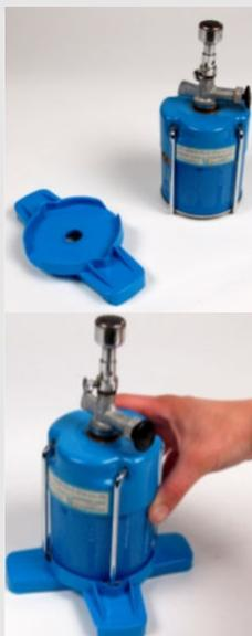
Присоедините бутановую горелку к бутановому картриджу, как показано на рисунках слева. Используйте спички, чтобы зажечь бутановую горелку.
